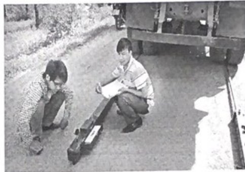
Đo môđun đàn hồi đường bằng cần Benkelman
