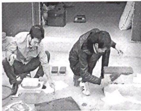
Gia công mẫu gạch bê tông thí nghiệm
